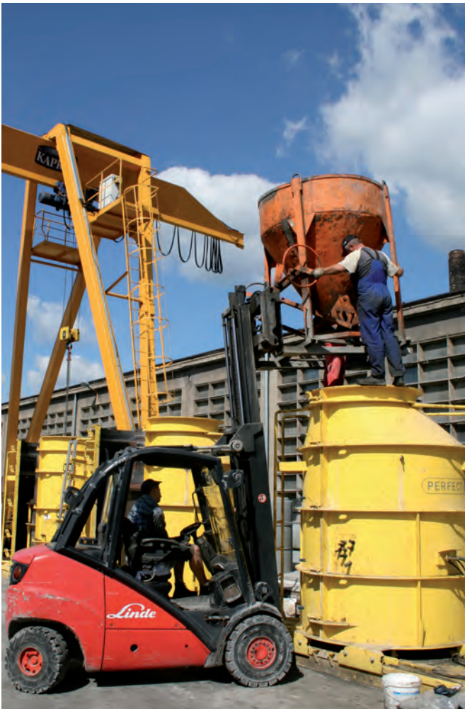
После достижения распалубочной прочности формы открываются, и конусы изымаются кран-балкой
