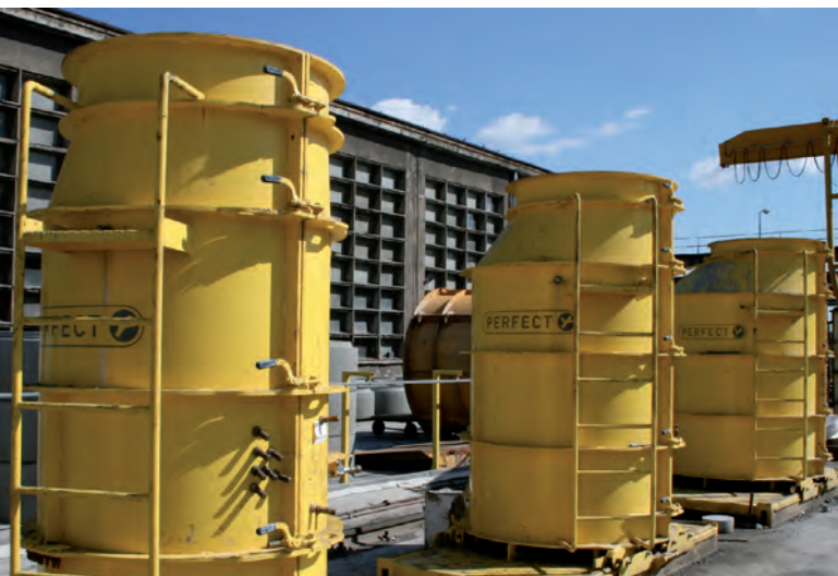
Три новых формы для монолитных конусов высотой до 2350 мм с внутренним диаметром 1,000, 1,200 и 1,500 мм
