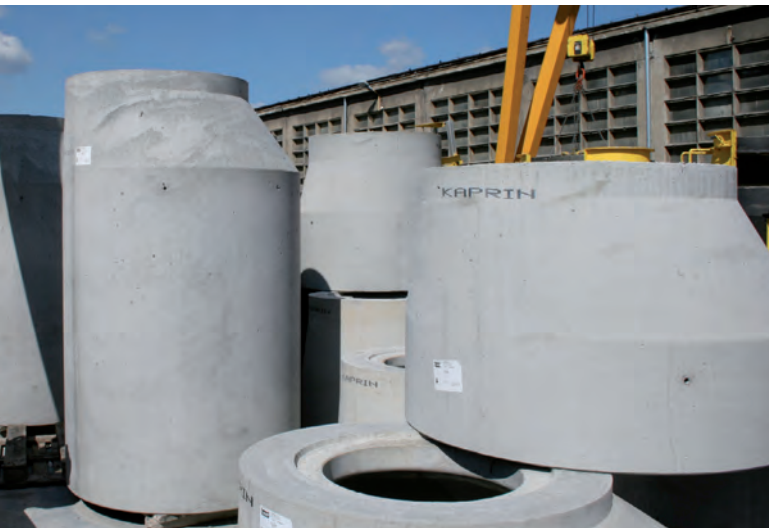
Высота конуса может быть установлена с переменными значениями - вплоть до максимальной высоты 2350 мм
