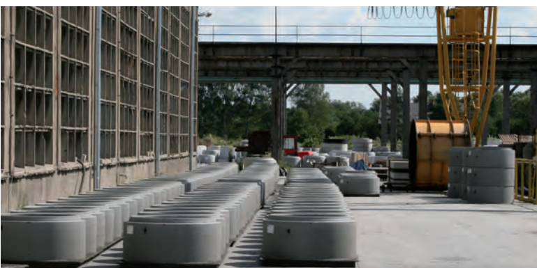
Монолитные кольца с дном Perfect компания Karpiń производит с 1997 года на оборудовании с высокой точностью от Schlüsselbauer
